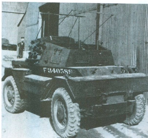
Boven: een naaoorlogse Mk.III, uitgerust met rookbuslanceerders en een eenvoudig frame voor het canvas dak;
